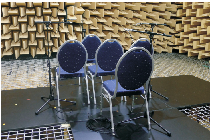
Rys. 1. Stanowisko pomiarowe w komorze bezdechowej
