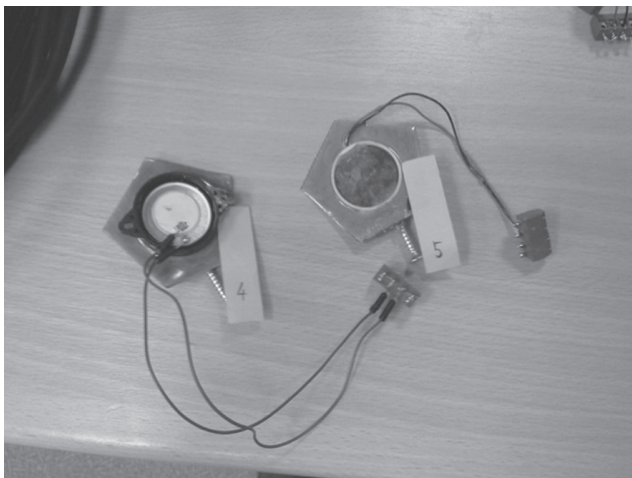
Rys. 5. Wybrane próbki piezoelementów użyte w badaniach
